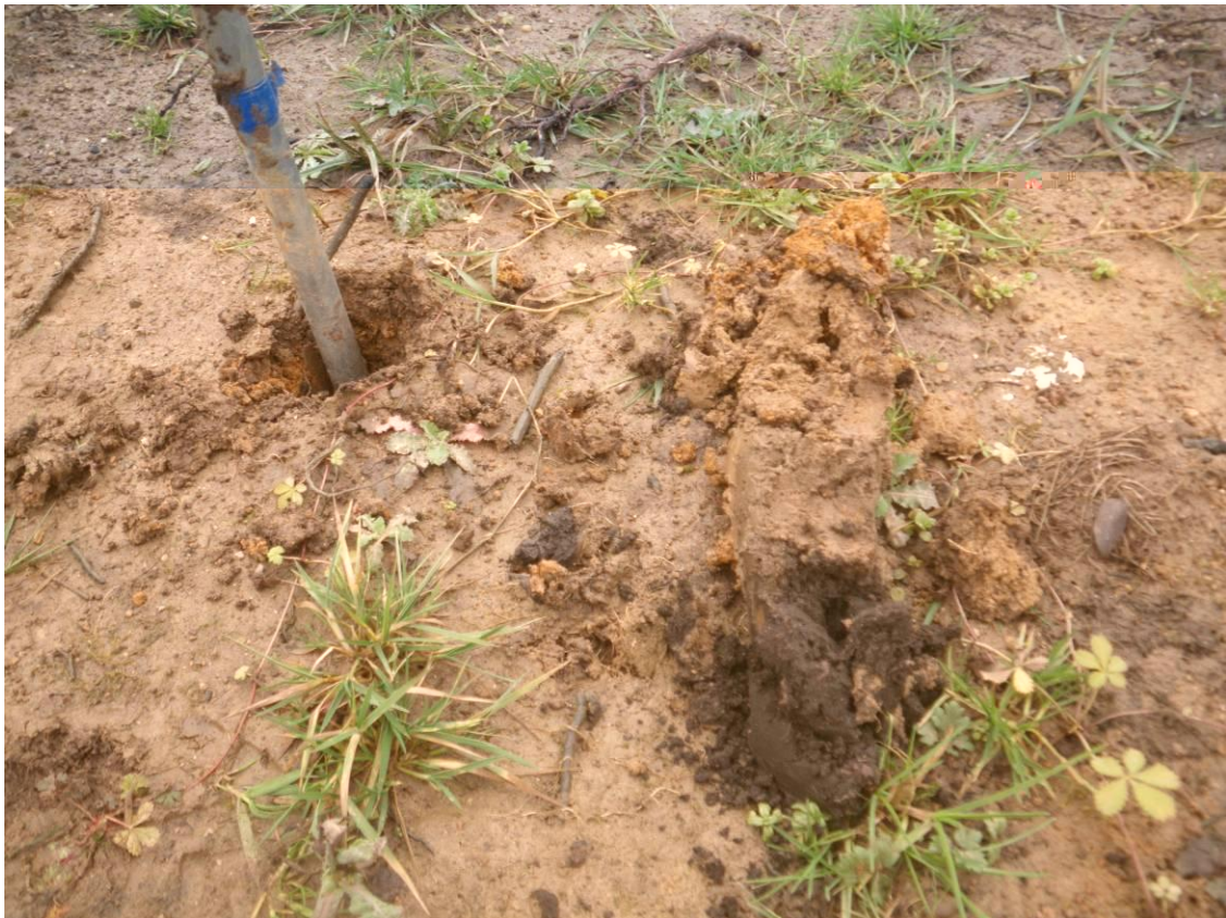
Photo 5 : Traces de remblais et cailloux en noir empêchant un carottage plus en profondeur
